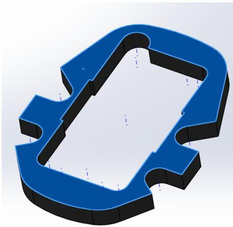
A l'aide du logiciel Solidworks, en reprenant les manipulations du mode opératoire proposé pour la réalisation d'une autre pièce, créer l'esquisse (2D) de la pièce **Mousse** puis le volume. Les cotations manquantes sont à prendre sur « la mise plan » avec le facteur d'échelle :
